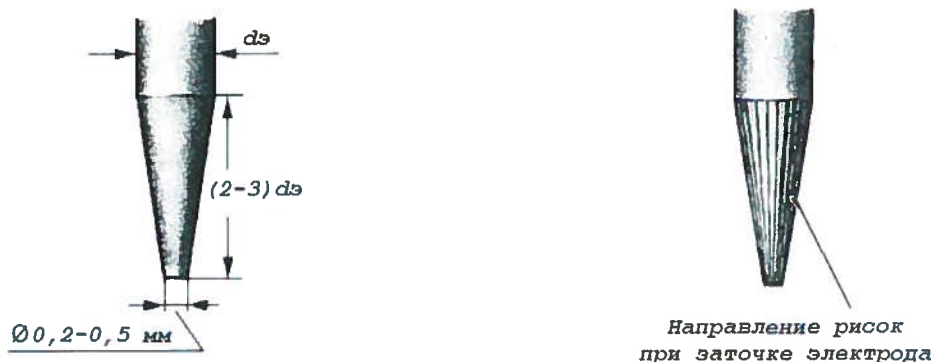
Рисунок 1 – Форма и направление заточки вольфрамового электрода
